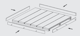
Completare al bisogno l'installazione con il profilo di chiusura perimetrale Complete the installation with the perimeter ending profile when necessary
