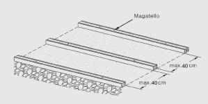
Interasse raccomandato fra un magatello e il successivo non superiore a 40 cm Recomanded space not larger than 40 cm between the joists
