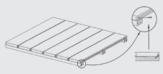
Utilizzare vite come indicato nel riquadro per fissare l'ultima doga Use the screw to fix the last slat as shown in the box above
