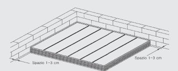
Prima di installare il prodotto assicurarsi di lasciare uno spazio da 1 a 3 cm dalla parete Before installing the product make sure to leave a space from 1 to 3 cm from the wall
